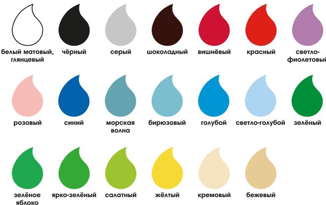
Высококачественная глянцевая алкидная эмаль. Изготовлена по специальным технологиям. Благодаря использованию импортных добавок и наполнителей, эмаль отличается высокими защитными и декоративными свойствами. Пленка эмали устойчива к воздействию температур от -50°C до +60°C. Покрытие, состоящее из двух слоев эмали, нанесенное на подготовленную, загрунтованную поверхность, сохраняет свои защитные свойства в течение четырех лет, а декоративные - в течение года.
