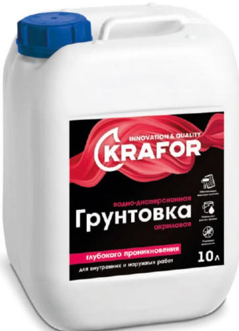
Используется для отделки стен из бетона, кирпичной кладки, гипсокартонных панелей, цементной штукатурки, других минеральных, а также деревянных поверхностей. Предназначена также для грунтования полов перед нанесением самовыравнивающихся смесей. После высыхания грунтовка образует прозрачную пленку и выравнивает впитывающую способность основания. Повышенная проникающая способность (от 1 до 5 мм) и закрепляющая способность.
